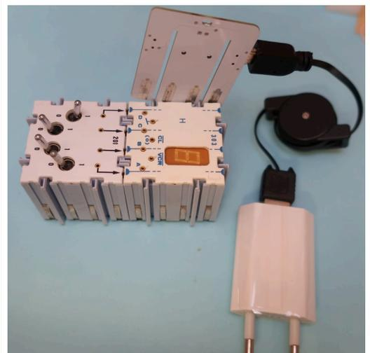
Ce qui est intéressant avec les circuits logiques, c'est que les deux états logiques sont bien distincts, pas d'état intermédiaire comme avec des capteurs. Les circuits dans les boîtes sont faits pour accepter des "mauvais" états (une tension de 1 Volt comme "0") et donner plus loin des "bons" états (une tension inférieure à 0.2 Volt). C'est pour cela que les ordinateurs sont si fiables ; l'information ne se dégrade jamais.
