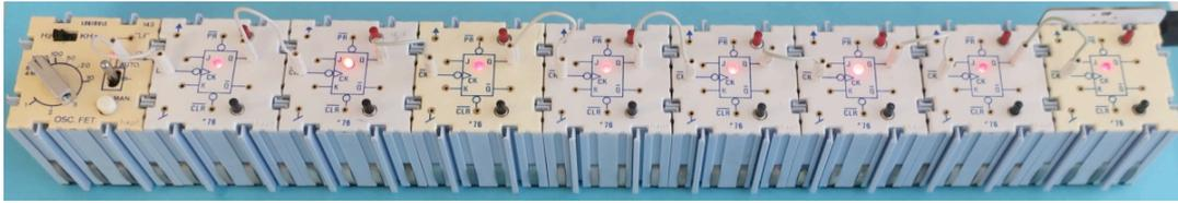
Chaque étage divise par 2. On voit dans ce tableau jusqu'où on peut compter sans truc logiciel avec un microprocesseur 8bits, 16 bits, 32 bits.
