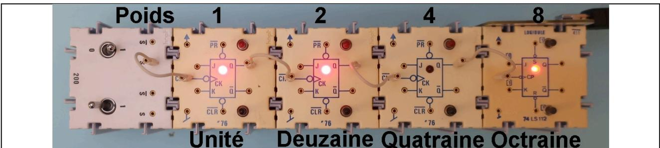
Pensez aux roues du compte-personne : quand une roue passe de 9 à 0, la roue suivante doit avancer. En binaire c'est toutes les 2 fois, quand une bascule passe à zéro, la suivant change d'état. Le compteur décimal a des roues pour les unités, dizaines, ... On peut s'amuser à inventer des noms pour le binaire : deuzaines, quatraines, huitaines...
