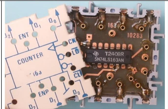
Le circuit 74163 est un compteur binaire 4 bits (sorties Q3 Q2 Q1 Q0 de poids 8 4 2 1) qui compte donc par 16 les impulsions du signal Ck (clock).
