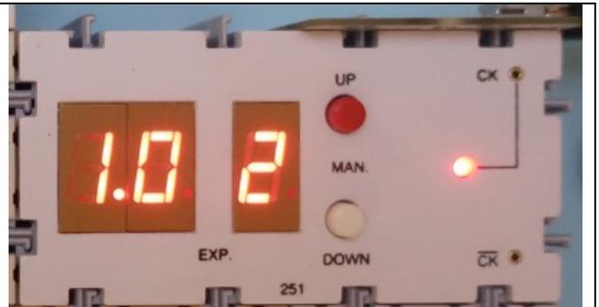
Le second oscillateur a 2 poussoirs pour changer la fréquence, affichée en unités et exposant. Sur la photo, il affiche 100 Hz ( $1,0 \times 10^2$ ).
