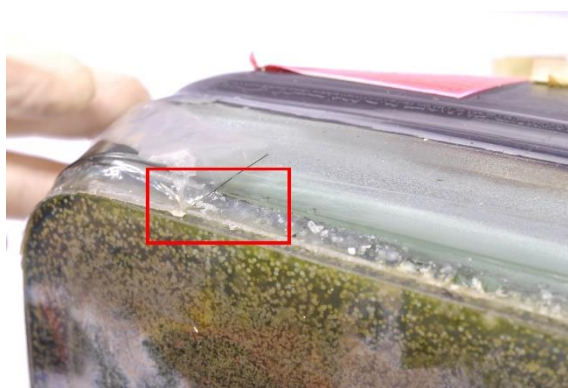
Figure 32 Exsudation observée sous la bande adhésive et sur l'adhésif entre l'écran de protection et l'écran du tube cathodique © HE-Arc, N. Nydegger 2019
