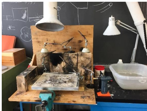
Figure 114, place de travail pour le test de Beilstein © HE-Arc, N. Nydegger, 2019
