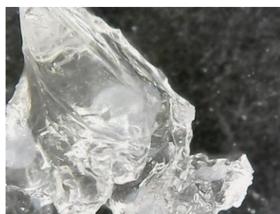
Figure 44 Echantillon d'adhésif après dissolution dans de l'acétone © HE-Arc, N. Nydegger, 2019
