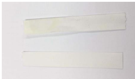
Figure 110 Après l'ajout que quelques gouttes de peroxyde, le papier est redevenu blanc (haut) © HE-Arc, N. Nydegger, 2019
