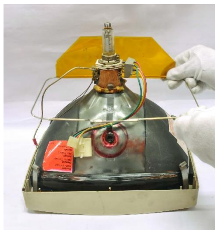
Figure 96 VR201, soulever le cerclage métallique © HE-Arc, N. Nydegger, 2019
