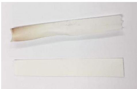
Figure 109 Après le test du cheveu, le papier est devenu brun (haut) © HE-Arc, N. Nydegger, 2019
