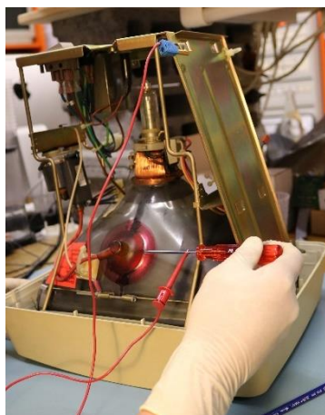
Figure 76 VT220, décharger le tube cathodique en reliant l'anode à la terre © HE-Arc, N. Nydegger, 2019
