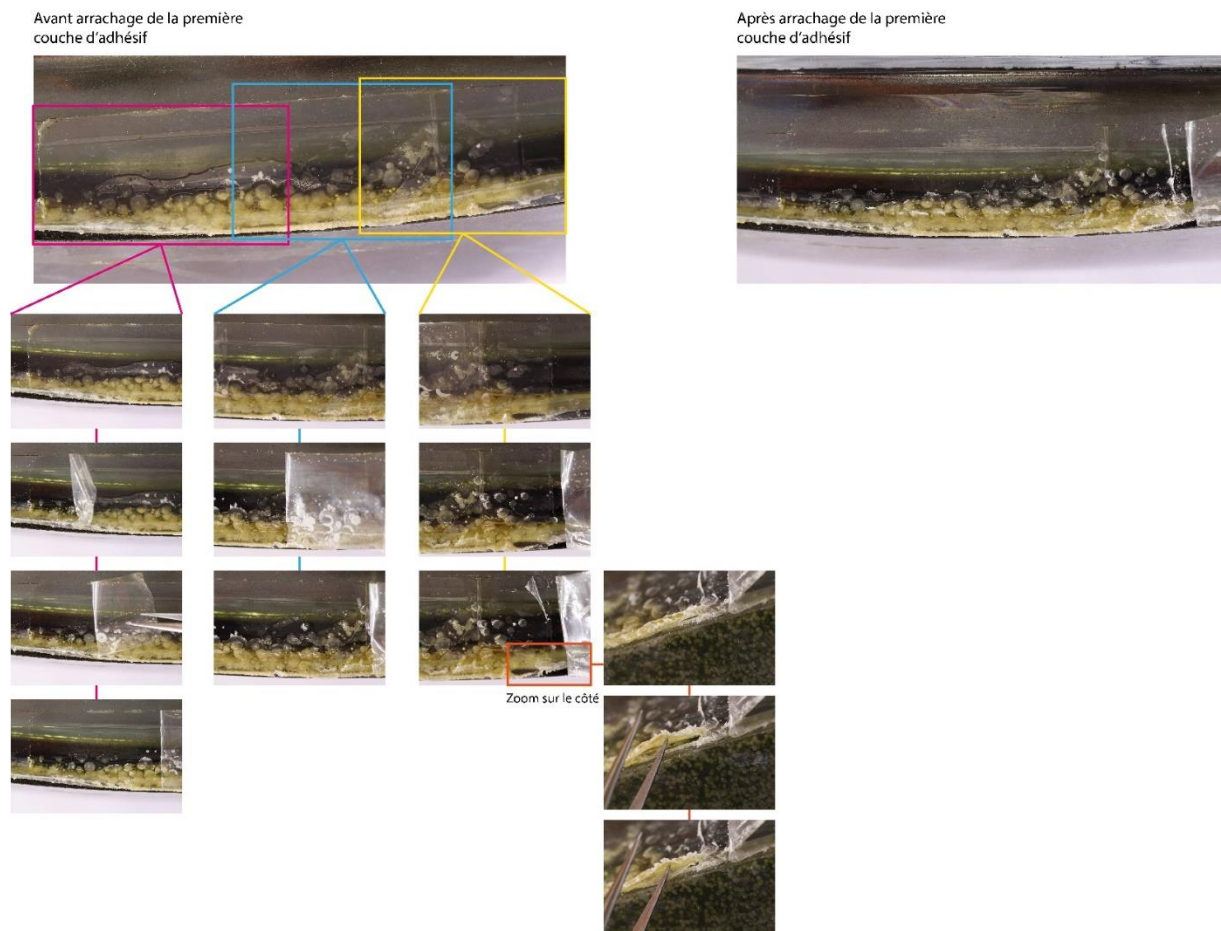
Figure 156 Test d'enlèvement de la première couche de bande adhésive, au niveau de la superposition. Ecran VR201 © HE-Arc, N. Nydegger, 2019
