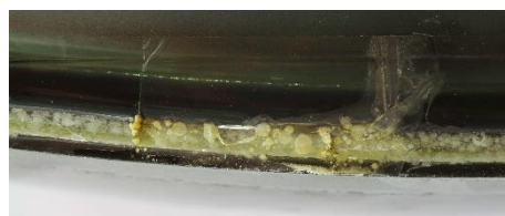
Figure 19 Zone de superposition de la bande adhésive qui fait le tour de l'écran VT220 © HE-Arc, N. Nydegger, 2019
