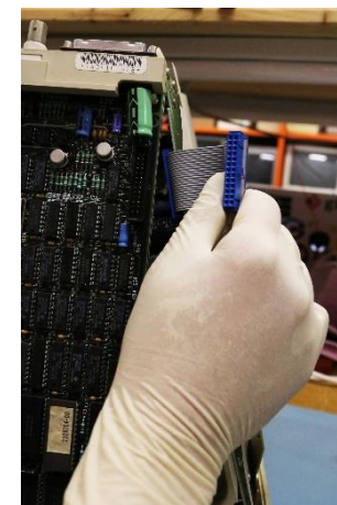
Figure 57 VT220, câble plat déconnecté © HE-Arc, N. Nydegger, 2019
