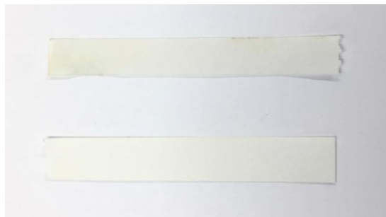
Figure 112 Après le test de l'échantillon, le papier n'a pas changé de couleur (haut) © HE-Arc, N. Nydegger, 2019
