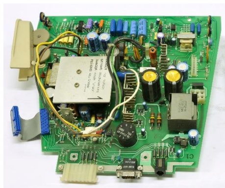
Figure 74 VT220, côté intérieur du circuit imprimé comportant les composants de fonctionnement © HE-Arc, N. Nydegger, 2019
