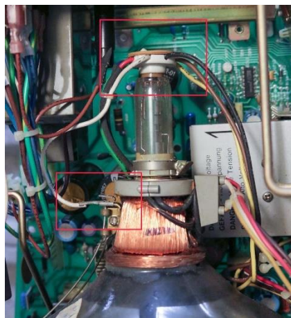
Figure 67 VT220, En bas : câble blanc de terre. En haut : connecteur rond © HE-Arc, N. Nydegger, 2019
