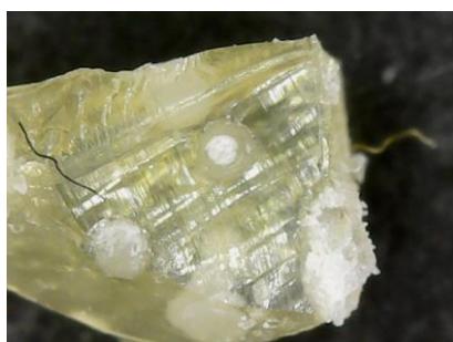
Figure 43 Echantillon d'adhésif avant dissolution © HE-Arc, N. Nydegger, 2019
