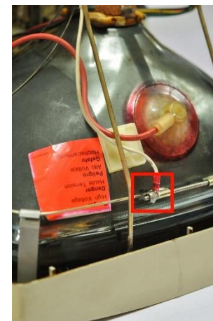
Figure 88 VR201, câble de terre relié au cerclage métallique © HE-Arc, N. Nydegger, 2019
