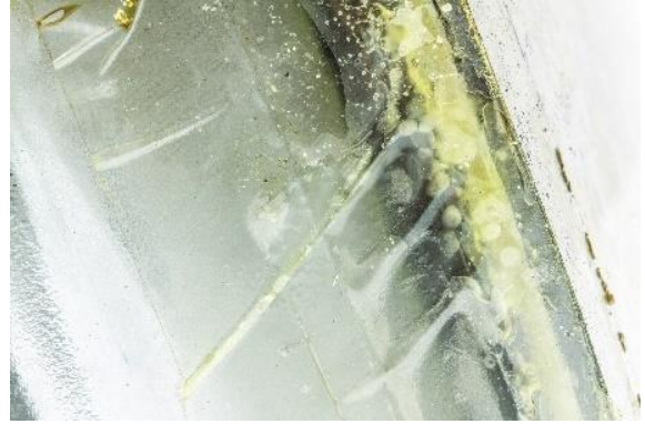
Figure 175 Bande adhésive sur les côtés de l'écran © HE-Arc, N. Nydegger, 2019
