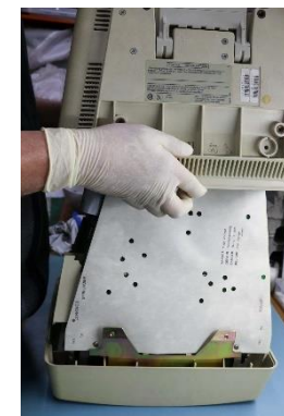
Figure 55 VT220, enlever le couvercle d'accès © HE-Arc, N. Nydegger, 2019
