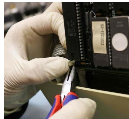
Figure 61 VT220, pincer le blocage et dégager gentiment le circuit imprimé © HE-Arc, N. Nydegger, 2019
