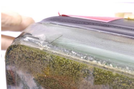
Figure 48 VR201 qui a commencé à suinter au bout de 6 semaines © HE-Arc, N. Nydegger, 2019
