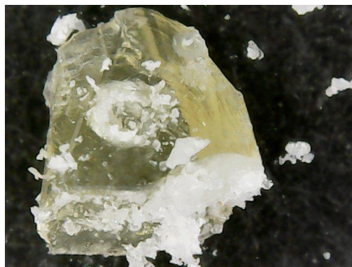
Figure 31 Même échantillon d'adhésif après avoir cherché à gratter la sphère avec la pointe d'un scalpel © HE-Arc, N. Nydegger, 2019
