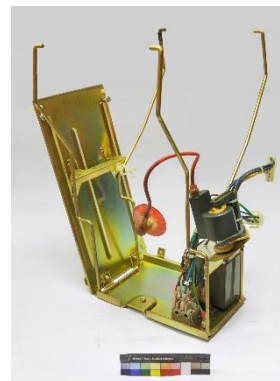
Figure 11 VT220, châssis avec les composantes de l'anode © HE-Arc, N. Nydegger, 2019
