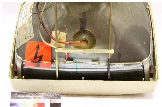
Figure 163 coulure vert turquoise sous l'écran, arrivant jusqu'au bouton d'anode © HE-Arc, N. Nydegger, 2019
