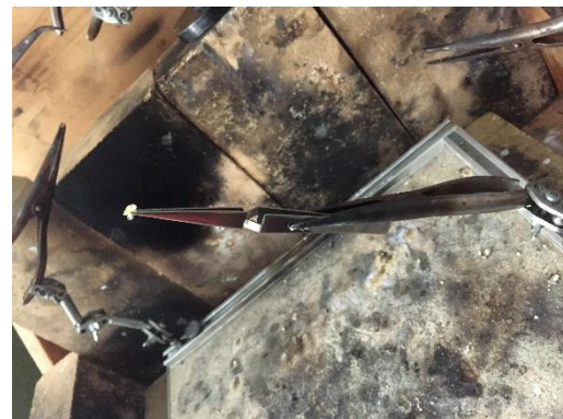
Figure 115 Disposition des pinces et de l'échantillon © HE-Arc, N. Nydegger, 2019
