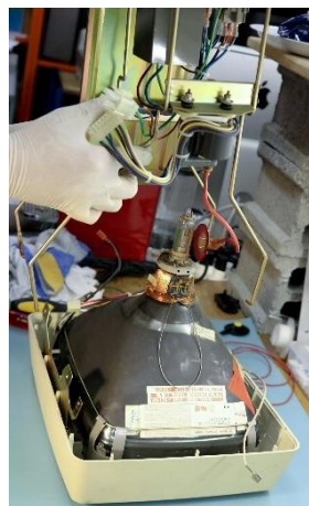
Figure 81 VT220, châssis retiré © HE-Arc, N. Nydegger, 2019
