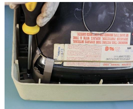
Figure 83 VT220, une des quatre attaches de l'écran au boîtier © HE-Arc, N. Nydegger, 2019
