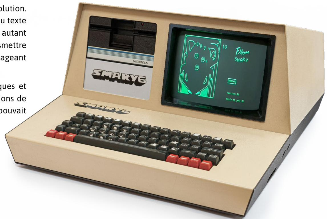
*Doté d'une résolution graphique de 256 par 160 pixels, il pouvait être mis en réseau via le système Cobus*
