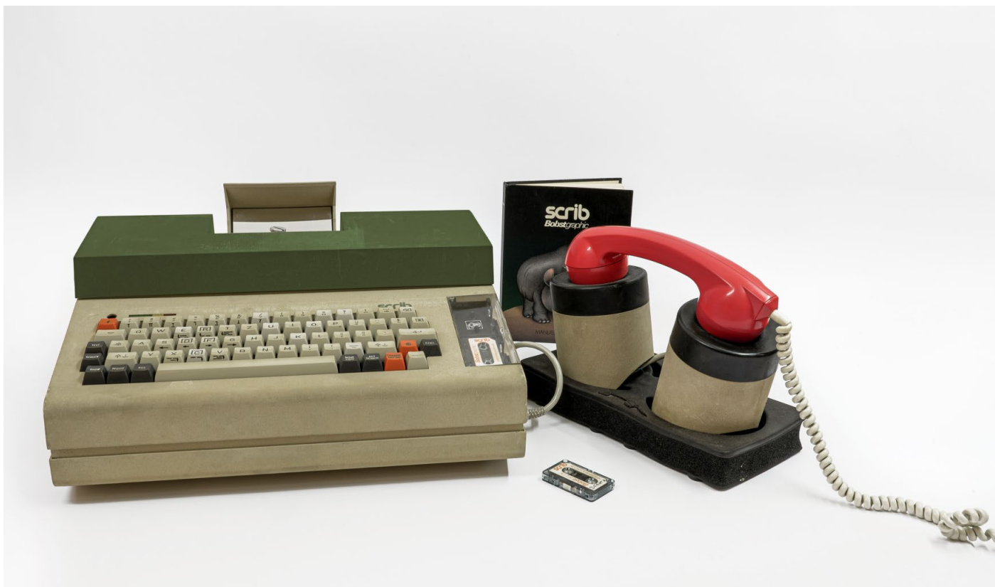
Le Scrib – 1978 | Une collaboration EPFL - Bobst Graphic Ordinateur portable de 16kg, destiné à la rédaction et à la transmission de textes dans la presse écrite. Cet appareil a remporté le prix d'excellence lors de la WESCON à Los Angeles aux Etats-Unis en 1978.
